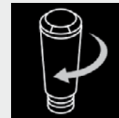
Visser le filtre dans le réservoir d'eau
